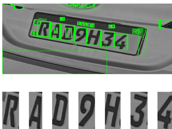
Figura 3 – Aplicação do Filtro MSER
