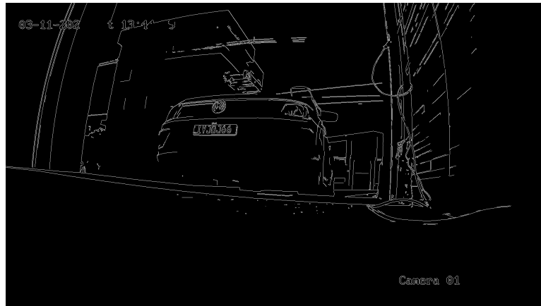
Figura 4 – Imagem transformada com a função Canny
